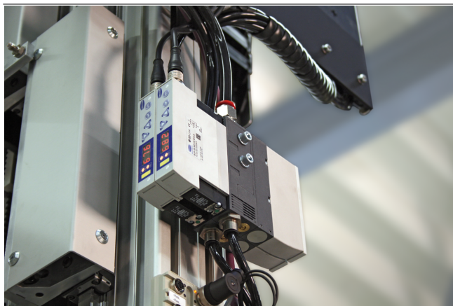
Generación de vacío centralizada mediante los eyectores compactos SMPi
